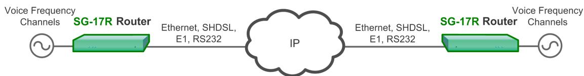
Рисунок 3.22. Передача каналов ТЧ в режиме маршрутизации
