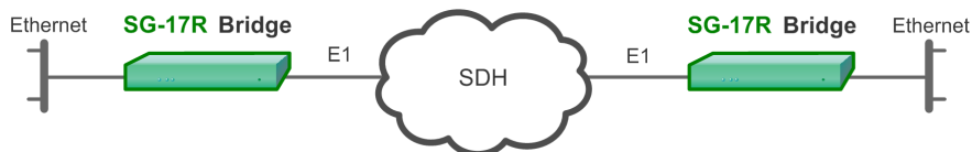
Рисунок 3.7. Объединение Ethernet сетей через канал E1 с использованием транспортных технологий SDH/PDH
