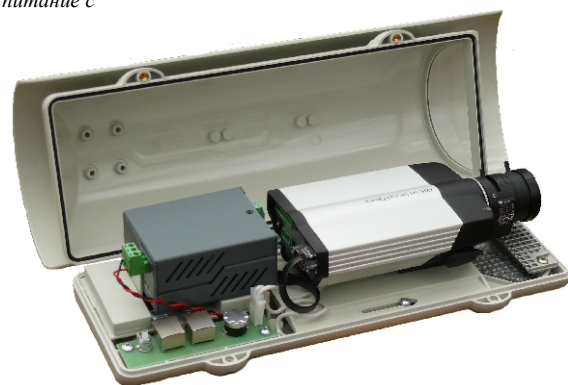
c Пример размещения модема SG-17BT с камерой Axis 221 в термокожухе Videotec с классом защиты IP66
